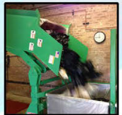
Contenedor / Carrito descargador que descarga una basura regulada de una yarda cúbica en un carro de alto volumen para autoclave.
