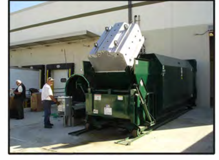
Descargador de horquilla de carga final volcando carros de autoclave de gran volumen en compactador autónomo.
