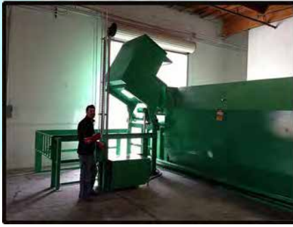
Dumpers de carro de carga lateral que descargan carros de autoclave de gran volumen en compactadores autónomos.
