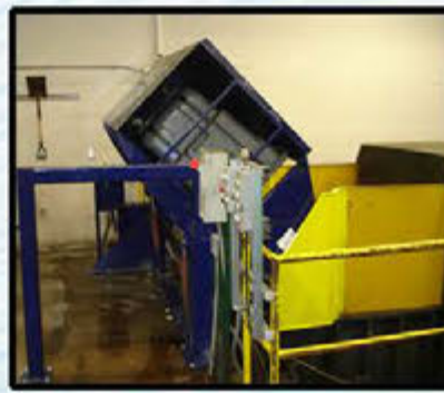
Dumper de carga lateral con una yarda cúbica Inclinación de tolva volcado en compactador autocontenido.
