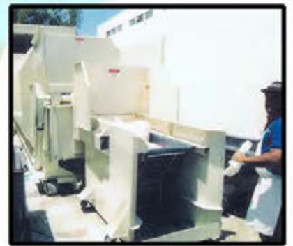
Carga final: descarga de accesorios de dumper de carro portátil Una tolva de inclinación de yarda cúbica en compactador autónomo.
