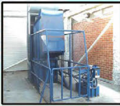
Dump del carro de carga final con una inclinación de una yarda cúbica tolva volcando en la rampa de carga.
