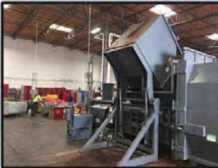
Carro de carga lateral descargador que descarga carros de autoclave de gran volumen en un compactador estacionario.
