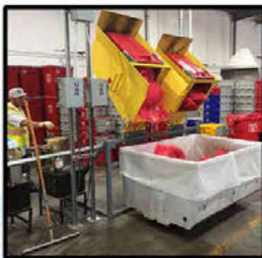
Descargador de contenedores / carros con dispositivo de descarga de contenedores portátil descargando contenedores de varios tamaños de RMW en un carro de alto volumen para autoclave.
